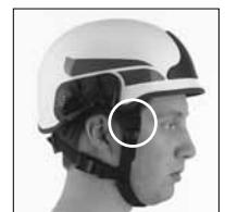
Die Länge des Kinnriemens lässt sich individuell für unterschiedliche Gesichtsformen an zwei Positionen einstellen. Die senkrecht verlaufenden Bänder können über die links und rechts befindlichen Doppelstegschnallen in ihrer Länge angepasst werden.
