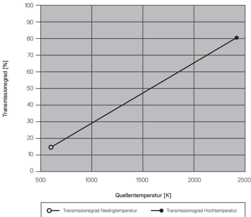
Wie aus diesem Bild ersichtlich, ist der von den HighTemp Visieren gebotene Schutz gegen Strahlungswärme von der Temperatur der Wärmequelle abhängig. Je höher die Temperatur ist, umso höher ist die schädigende Wärme, die auf das Auge trifft. Das Visier sollte nur in Situationen eingesetzt werden, in denen es die Exposition des Auges des Trägers auf weniger als  $100 \text{ W/m}^2$  reduzieren kann.
