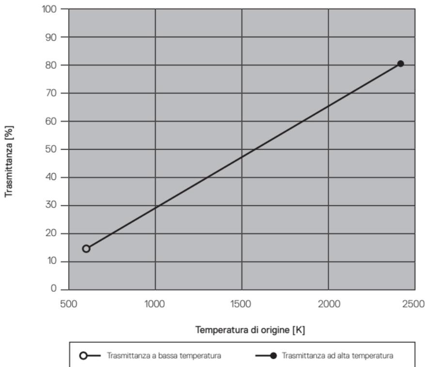
Come si può vedere da questa immagine, dipende dalla protezione offerta dalle visiere HighTemp contro l'irraggiamento termico della temperatura della fonte di calore. Più alta è la temperatura, più alto è il calore dannoso che colpisce l'occhio. La visiera deve essere utilizzata solamente in situazioni in cui può ridurre l'esposizione degli occhi di chi la indossa a meno di 100 W/m<sup>2</sup>.
